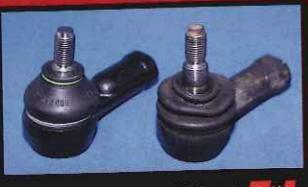
新旧タイロッドエンドの比較。これにガタが出てしまうと、直進安定性やステアリングフィールに悪影響が出る。トータルはここで調整するので、交換後にはアライメントの確認が必要になる。
