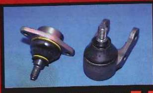
ブッシュ類の交換作業がすべて終了したら、下側(写真右)のボールジョイントも新品へと交換して上下のアームを組みつける。分解するときにはあんなに苦労したはずなのに、組み立てるほど簡単に終わってしまった。
