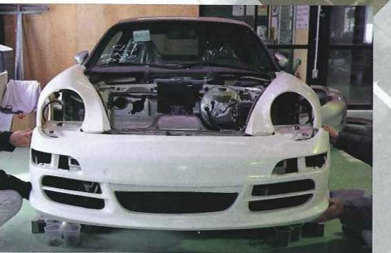
これがアメリカの某メーカー製のキットを被せてみたところ。このキットは左右のフェンダーとフロントバンパーの3点セットになっており、ヘッドライトやマーカー類は997用の純正パーツを使用するようになっている。正面から見ると、一応それらしく付いているように見えるのだが、現実にはボルトオンで装着することは絶対不可能。仮にこれを大改造して装着したとしても、到底ポルシェのクオリティに仕上がるとは思えない。さてどうしよう。メーカーの広告の写真では、ちゃんと装着しているように見える写真が出てはいるのだが、どう考へてもこのキットを装着したとは思えない。
