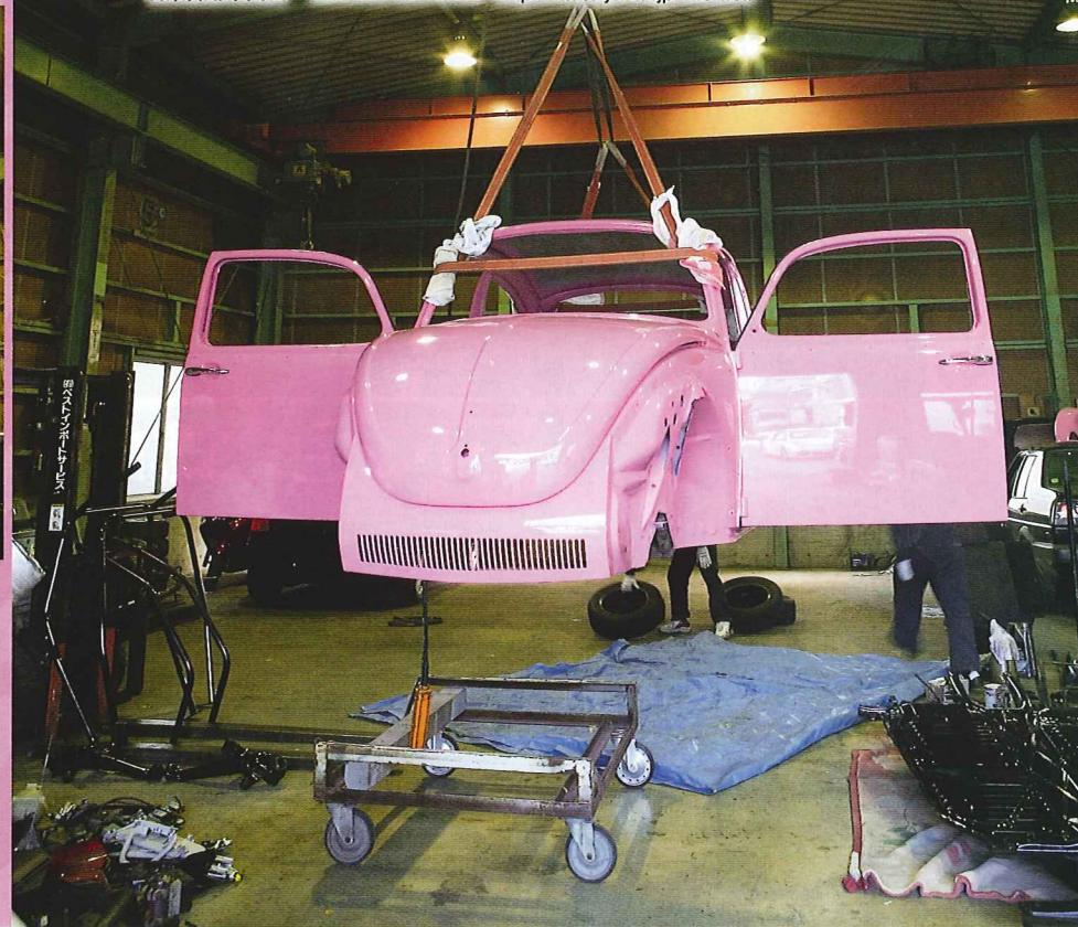
というわけで、今回は作戦変更。BISの第二倉庫にあったクレーンを使って、ボディを載せるという作戦に変更することにしました。そういえば、新車時の組み立てラインの記録映画を見て、上からクレーンで吊つてボディを載せる作業をしてましたね。
