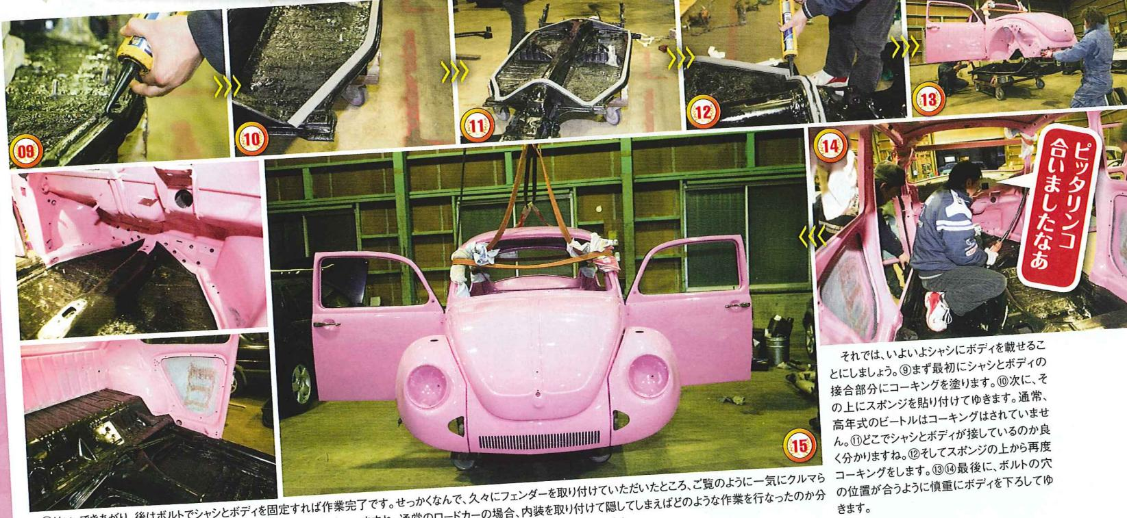
⑯はい、できあがり。後はボルトでシャシとボディを固定すれば作業完了です。せっかくなので、久々にフェンダーを取り付けていただいたところ、ご覧のように一気にクルマらしく見えるようになりました。なんとなく先が見えてきたような気がしちゃいますね。通常のロードカーの場合、内装を取り付けて隠してしまえばどのような作業を行なったのか分からなくなってしまうのです。しかし、このピンキーのような草レース仕様車の場合は、手抜きをすればちゃんと見えてしまうんですね。
