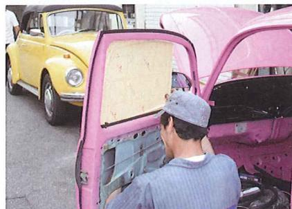
いつの間にかウィンドウの装着を完了していた高木メカ。紙を張ったままにしているのは、作業時にアクリルのウィンドウに傷がつかないようにするためです。
