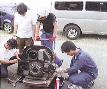
エンジンを搭載する前の下準備をするBISの山崎社長とマモル君。空冷VWのエンジンは下から入るので、ガレージジャッキと馬があれば作業ができます。
