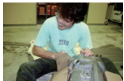
後期型のアルミ地カバーなら、外したついでにピカール磨きを施したい。水ペーパーで研磨後に磨けばピカピカ仕様に生まれ変わる！
