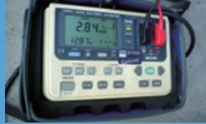
バッテリー内部の抵抗値が2オーム台で、一般のバッテリーと比べて少ないのが特長。瞬発力にも富む。
