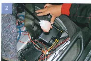
右リアシートを取り外し、エアポンプを取り出す。スポンジに包まれているので取り出しに注意。四角いカプラから電源を取り出す。
