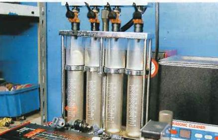
インジェクターのテスト風景。毎回インジェクターのテストをしてから使用。圧倒的強大パワーの秘密はこうした小さな蓄積であろう。
