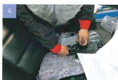
左リアシートを取り外し、モジュールから太い配線の中からウインカーに繋がる配線を探し出して、キーレス配線に接続、ダイオードも忘れずに。
