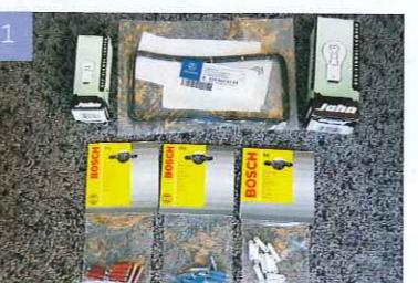
日常メンテで交換した部品、ヒューズセット、電球、そして湿気進入を防ぐヒューズボックスのゴムパッキン。転ばぬ先の杖で車検毎の交換がおすすめ。
