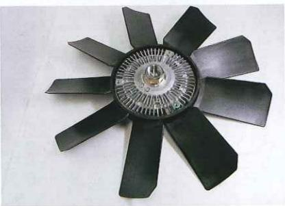
E55用9枚羽根ファン。ファン形状の改良によりW124/500E用のものより軽量&amp;高効率だ。
