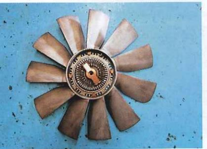
M120V12用11枚羽根ファン。冷却効果は高いがマグネシウム製で重いと高価なのが難点。
