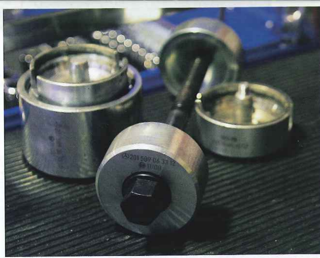
メルセデスのフロント・ロアアームブッシュ交換に使用するSST（スペシャル・サービス・ツール）。モデルごとに専用部品が設定されているため、揃えるのは大変だ。
