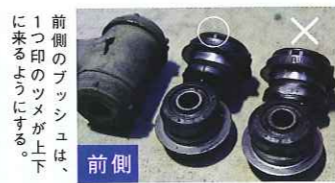
前側のブッシュは、1つ印のツメが上下に来るようにする。後側の場合は、2つ印のツメが上下に来るように圧入する。
