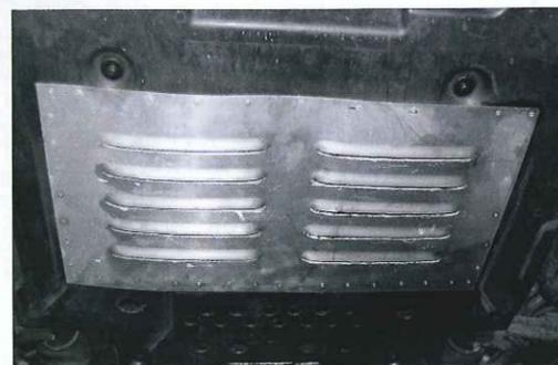
エンジンルームの空気の抜けが極端に悪い E500E にはダクト加工が有効。アンダーカバーにルーバーを設けることによりラジエターの熱気を効果的に排出する
