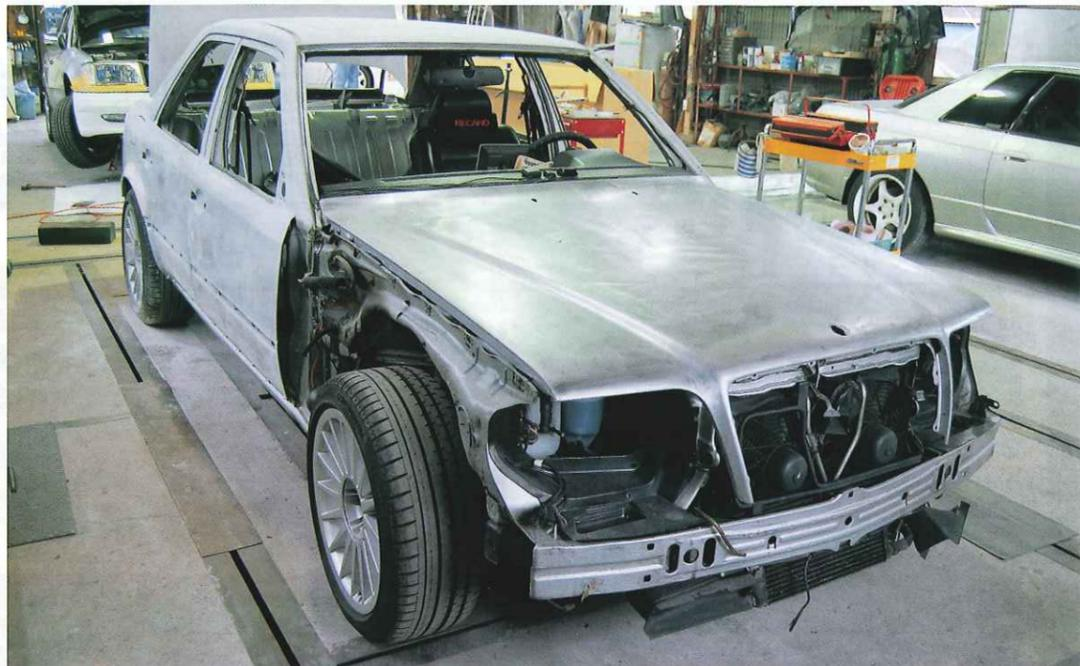
ガラスも外れフェンダー、ボンネットの総剥離が済んだヘアライン車。塗装直後は分からなくても数年後に確実に差が生じるので、誤魔化さない丁寧な下地処理が不可欠だ。
