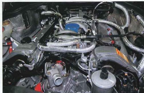
新エンジン搭載時に熱対策を行なったエンジンルーム。燃料系の断熱はガソリン温度の上昇防止に有効。熱せられたガソリンでは冷却に不利だしパワーも出ない。
