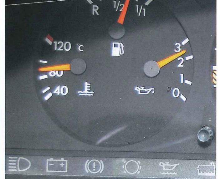
水温はブロック温度 70℃、メーターではこの位置が理想。水温遅角補正が入るため 105℃超では、鈍い人でも体感でパワー低下を感じる。
