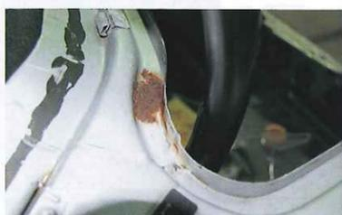
新車並行で室内保管した車でも生じてくるトランクモール回りの錆。つつくと小さな穴が開いてしまったのでロウ付けで補修後、下処理を行う。
