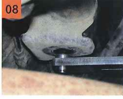
08 アームの足が取り付け穴の真下にくるようにすれば、調整はOK。これでツールを外せばいい。
