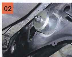
02 これは外側のカップを当てているところ。内径がサブフレームの穴の径と同じになっている。
