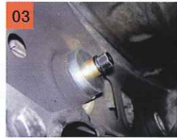
03 これが内側のカップ。マウントと同じ外径で、ネジを締めるとマウントを押し出して行く。
