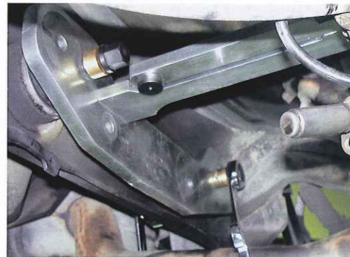
SSTを使った作業のクライマックスとも言える、調整ツールによってデフマウントの穴位置調整を行なっているところ。
