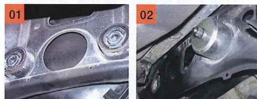
01 劣化が進んだデフマウントをリア側から見ると、中央の穴位置がズレてきたら交換時期。
