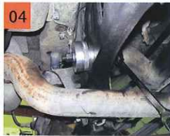
04 新しいマウントを圧入しているところ。中央のネジを締め込むことで、マウントを押し込む。
