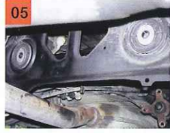
05 圧入された新品のマウント。この後、位置合わせのためのツールを両側の穴に取り付ける。
