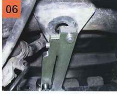
06 取り付けただけの状態では、アームとフロント側の取り付け穴はこれだけズレていた。
