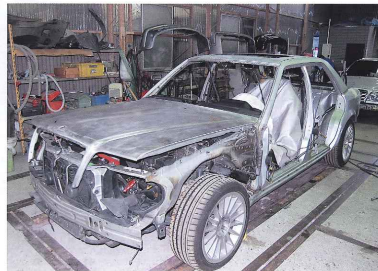
スポット増し、パルスミグ溶接&パネルボンド補強が完了したドンガラ状態のヘアライン号は、一流技術に最新機器で「鬼に金棒」。ヘタリや事故による剛性低下も、もう怖くない!
