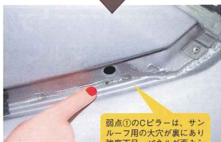
開口部をスポット増し。火花は出ずにシール剤が焦げてわずかに煙が立つだけの地味な作業だが効果は抜群。慣れた手つきでこなす。
