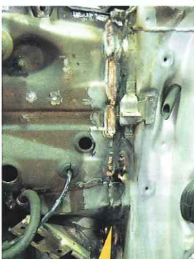
弱点②のAピラー付根。ここも鉄板の合わせ目をパルスミグで溶接していく。鉄板が割れたり、割れているクルマが多いので注意。
