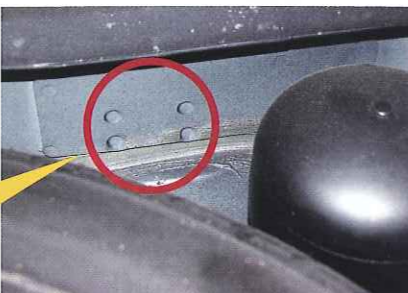
弱点②のAピラー付根。ここも鉄板の合わせ目をパルスミグで溶接していく。鉄板が割れたり、割れているクルマが多いので注意。
