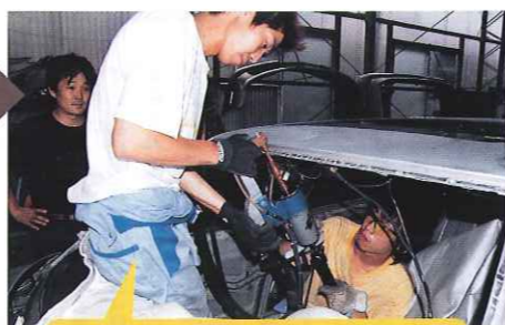
開口部をスポット増し。火花は出ずにシール剤が焦げてわずかに煙が立つだけの地味な作業だが効果は抜群。慣れた手つきでこなす。
