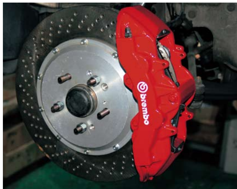
380mm ローターはポルシェ GT1 用。合わせる 8 キャリのピストン径は 34 × 26 × 2、ジュラルミン製のハットには硬質アルマイトを施す。
