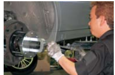
ホイール装着にはハブ交換が必要のため、SST を持つファクトリーで作業を依頼。
