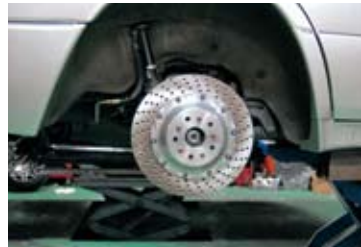
仮装着のリア 380mm ローターは、ワンオフのレクサス用。バックプレートが隠れる大迫力。
