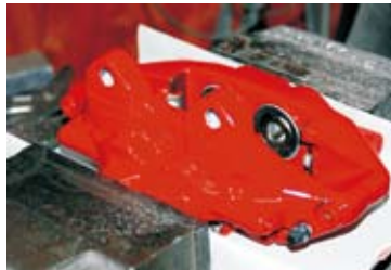
リアの4ポッドはピッチが違うため、W124 のハブキャリア装着には大加工が必要となる。
