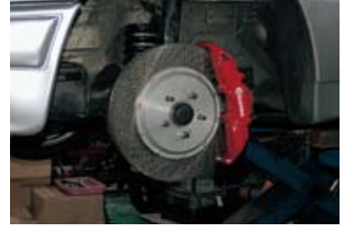
8キャリはラジアルマウント。ステーは鍛造スチールで、バックプレートのカット等の小加工で装着できる。
