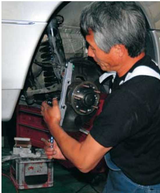
AMG キャリバーは 360mm 用のため、カラー装着で 380mm への大径化に対応。強度・剛性が必要な部分だ。
