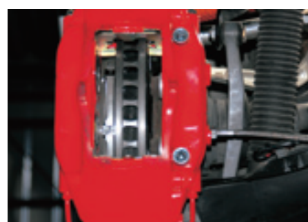
34mm厚のペーンが切られたローターとパッドの厚さがよく分かる。ブレーキホースはステンメッシュをチョイス。
