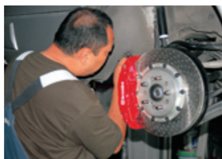
リアへのブレーキキット装着は、手早い作業と段取りで追加加工を含めて、わずか2時間強で終了した。
