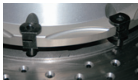
硬質アルマイト処理のハット部。軽量化のための肉抜きと熱膨張を吸収するフローティング加工が施される。
