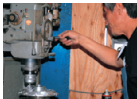
現車合わせに必要なジェラルミン製ハットの追加加工も同社で対応できるから車種ごとのワンオフはお手のもの。
