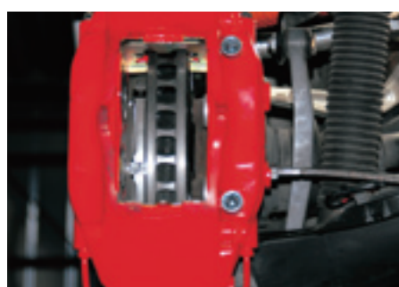
34mm厚のベーンが切られたローターとパッドの厚さがよく分かる。ブレーキホースはステンメッシュをチョイス。
