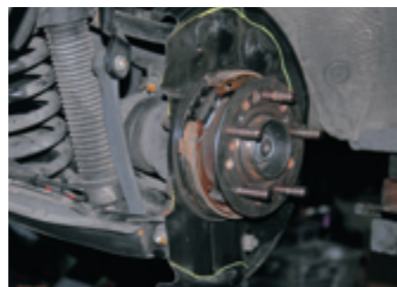
大径ディスクとボルシェ 993 ターボキャリパー装着のために、新品のバックプレートをざっくりと切断。
