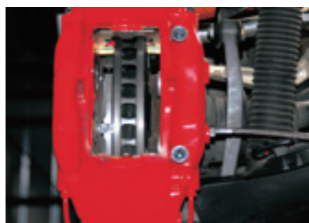
34mm厚のベーンが切られたローターとパッドの厚さがよく分かる。ブレーキホースはステンメッシュをチョイス。
