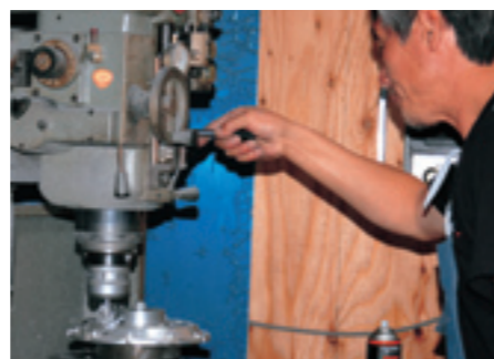
現車合わせに必要なジェラルミン製ハットの追加加工も同社で対応できるから車種ごとのワンオフはお手のもの。
