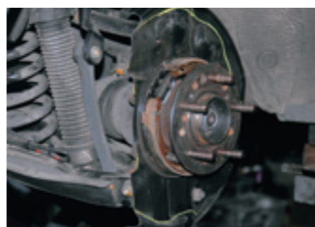
大径ディスクとボルシェ 993 ターボキャリパー装着のために、新品のバックプレートをざっくりと切断。
