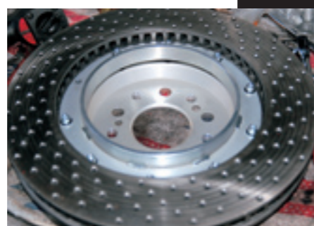
ペーンのリアローターの中にはサイドブレーキが入るため、特製のスチールドラムをセットする必要がある。
