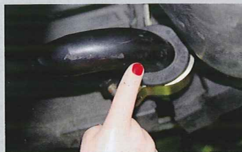
LSD未装着の弱アンダーのベンツには、フロントスタビだけ交換するより、痛みやすいブッシュを交換する方がメリットが大きい(写真はW202用ブラケット)。
