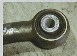
LSD未装着の弱アンダーのベンツには、フロントスタビだけ交換するより、痛みやすいブッシュを交換する方がメリットが大きい(写真はW202用ブラケット)。
