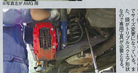
直径が純正より1mm太い29mmであるE60・AMG用スタビは、ロールを抑えるが、アンダーが出やすくなる。初期ロールやハンドルレスポンスを求めるなら、まずはブッシュとブラケットを交換するのがお勧め。
