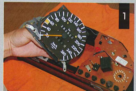
1 クルマから取り外したメーターパネルを分解して、まず速度計を取り外し、裏にある回路基盤を点検する。
