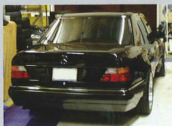
ショートロアアームを装着した写真。約0度のリアホイールのキャンバーの角度に注目。
