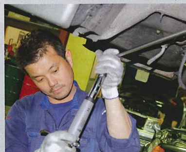
リフトアップして1Gを掛けるために、ミッションジャッキで位置決めをして、トルクレンチで締めこむ。
