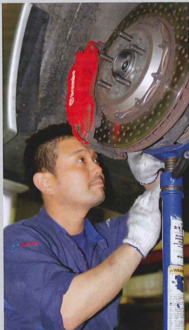
足回りの整備は、必ず車両重量がかかった状態でアーム類のボルト類を締めるのが基本。
