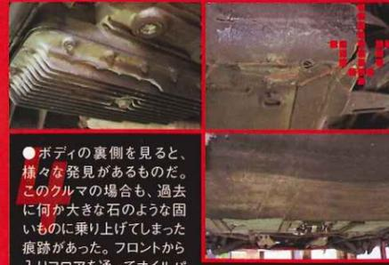
●ボディの裏側を見ると、様々な発見があるものだ。このクルマの場合も、過去に何か大きな石のような固いものに乗ってしまった痕跡があった。フロントから入りフロアを通してオイルパンに当たり(写真のようにアルミのフィンが一部欠けていた)、リアサスペンションをかすめて抜けている。恐らく相当な衝撃だったに違いない。最低地上高の低いクルマの宿命ともいえるが、当たりどころによっては全損コースになることもある。
