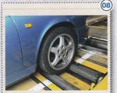
ハンドルを真っ直ぐ保持して直進しようとする際の 横滑り量を確認する「サイドスリップ」の検査を終え たら、フロントタイヤをローラーに乗せ、フロントブレ ーキが確実に効くかを確認します。
