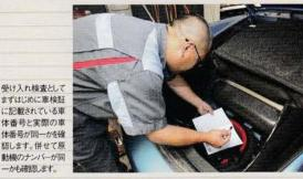
まずはじめに車検証 に記載されている車 体番号と実際の車 体番号が同一かを確 拠します。併せて原 動機のナンバーが同 ーかも確認します。
