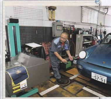
クルマを車検ラインに入れて各種チェックを行います。まずはヘッドライトの照度、光軸の上下、左右の振れを確 認。その他の灯火類も点灯するか確認します。
