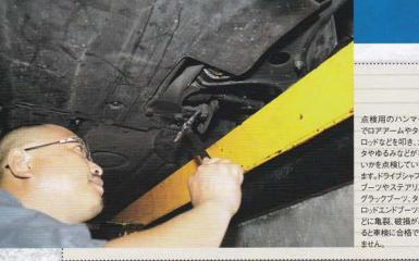
点検用のハンマー でロアアームやタイ ロッドなどを叩き、ガ タやゆるみなどがな いかを点検していき ます。ドライブシャフト ブーツやステアリン グラックブーツ、タイ ロッドエンドブーツな どに亀裂、破損があ ると車検に合格でき ません。
