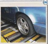
同じように今度はリアタイヤをローラーに乗せ、リアブ レーキが確実に効くかを確認。次にパーキングブレ キの効きも確認します。
