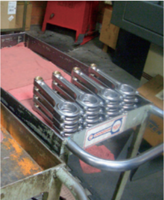
米国カーニングハム社で出来立てホヤホヤ、3台分のM119用コンロッド。放電加工されたオイル穴と長い芯間がよく分かる。
