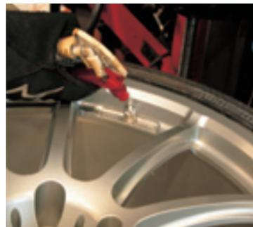
ホイール組み付け後、再度バルブからのエア漏れを石鹸水でチェック。山浦さんは、タイヤの空気圧管理の大切さを強調する。
