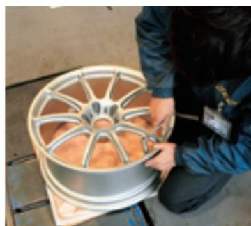
ホイールの下に敷いてあるピンク色のスポンジは、作業時のリムへの小傷防止用。手際良い作業の中にも気遣いが感じられる。
