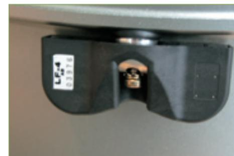
センサーユニットの重量は36グラムと、アルミバルブとでバランスの影響を極力低減。バッテリーの寿命も3~5年とロングライフ設定となっている。
