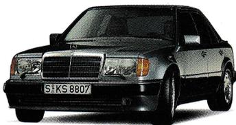
メルセデス・ベンツ500Eは、W124のEクラスのボディにSL(R129)用5.0 V8エンジンを搭載することで生み出されたハイパフォーマンス・セダン。発表は1990年で91年モデルより販売が開始されている。最高出力は330PS(後期モデルは325PS)で、当時の量産セダンとしては屈指の高性能車であった。本来、直6を上限に想定していたW124にV8を搭載するため、ボディ自体にも大きな手が入られている。日本への正規輸入は92~94年。本国でも95年にスペシャル・モデルであるリミテッドを最後に生産を終了している。実際の開発や初期モデルの一部製造工程のをボルシェに委託していたこともあり、そういう点でこのクルマを評価する向きも少なくない。
